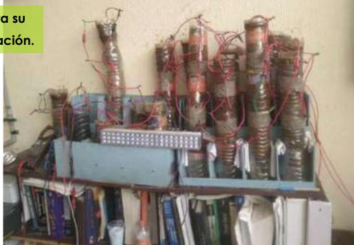
momento de pasar por el proceso de descomposición, se vuelve muy ácida. Al ser más ácido el ambiente, oxida más rápido la pila y nos genera hasta 50 miliamperes, que es lo que nos genera un pila fotovoltaica promedio".
