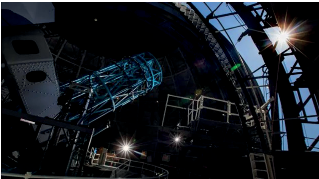
Imagen 4. Con un espejo de 100 pulgadas (2,5 metros) de diámetro para recoger la luz, el telescopio Hooker del Monte Wilson era el mayor telescopio de la época. Getty Images
