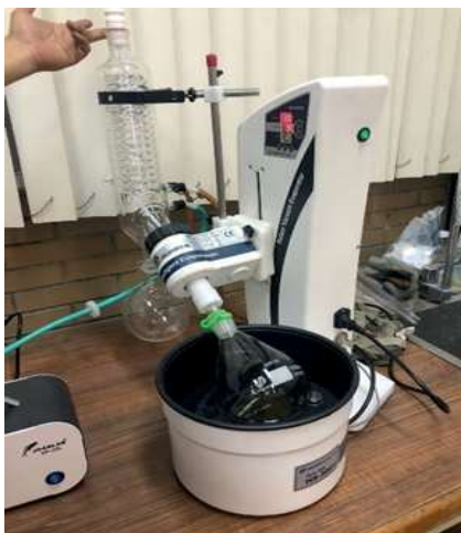
Imagen 3. Sistema de rotavapor, (Fotografía tomada por las autoras, 2025)
