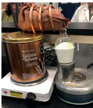
Imagen 2. Sistema de destilación por arrastre de vapor casero, (Fotografía tomada por las autoras, 2025).
